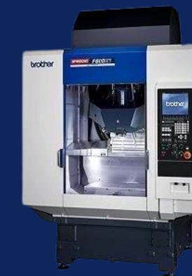
Serie Speedio "F" Centro de maquinado compacto de alta rigidez
